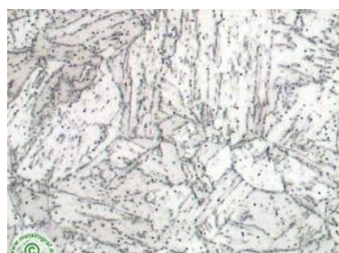
Precipitado a 590°C: Martensita con presencia de Ferrita y precipitados
